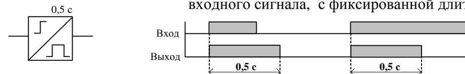
Формирование выходного сигнала по заднему фронту входного сигнала, с фиксированной длительностью
