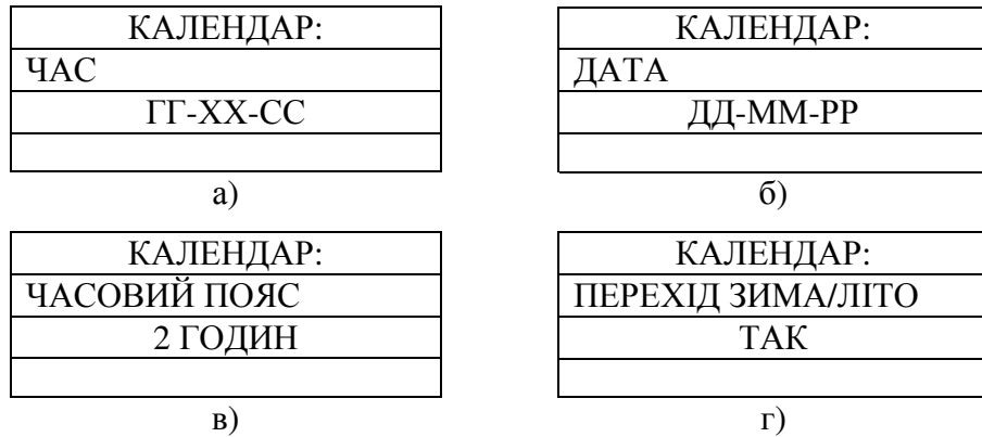
Рисунок 2.2 – Перегляд та налаштування поточної дати та часу на РКІ
