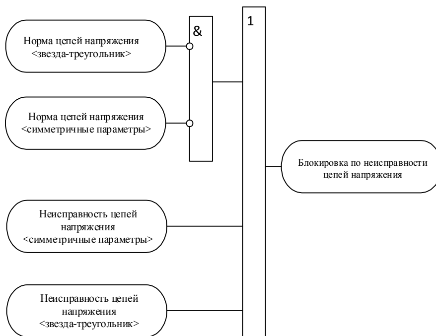
Рисунок 1.3.14 – Функциональная схема формирования сигнала "Блокировка по неисправности цепей напряжения"
