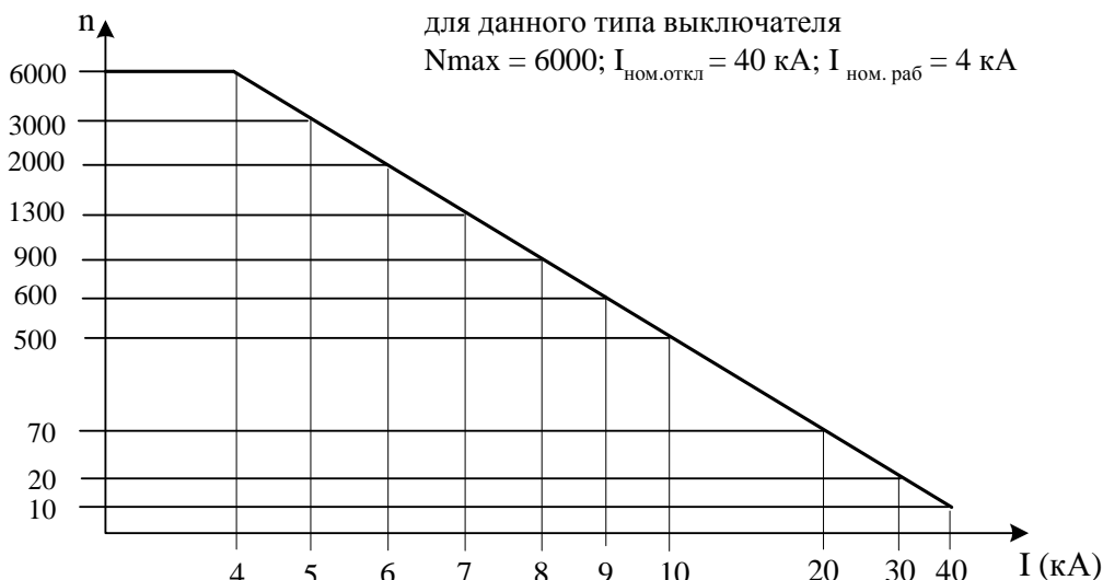
Рисунок 1.3.11 - Допустимое количество отключений в зависимости от тока отключения
